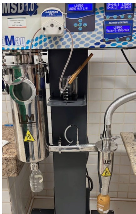
Figura 1 – Equipamento spray dryer para secagem em escala laboratorial do shoyu pó.
